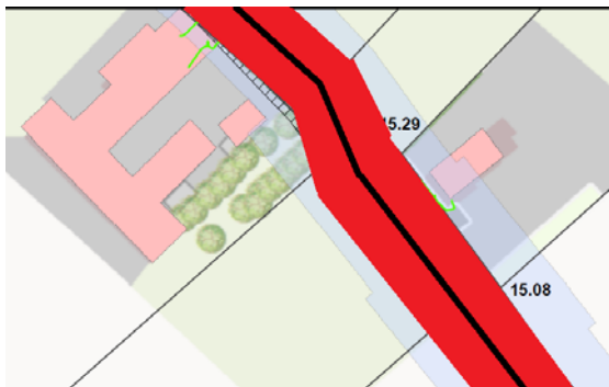
Figuur 1: De waterkering uitgezet vanuit de rand van de perceelgrenzen.
