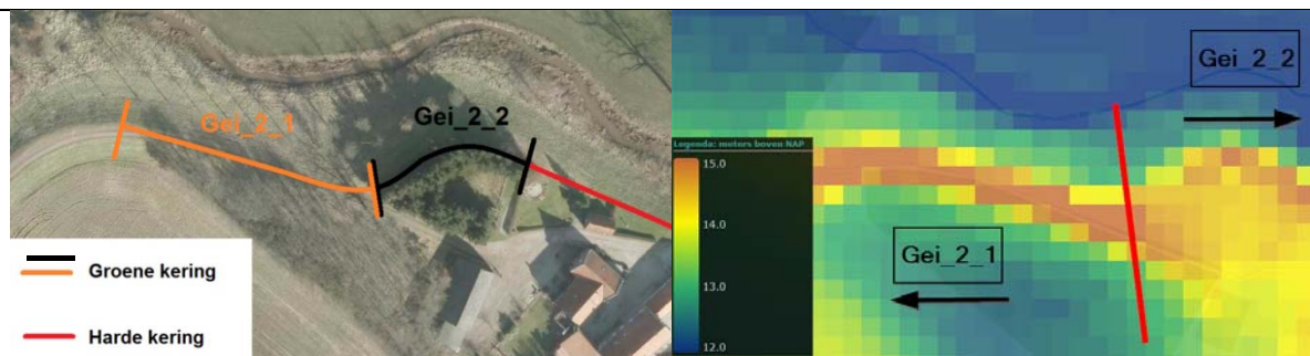
Figuur 1: Onderverdeling dijkvak Gei 2 op basis van aangetroffen verschil in binnendijs maaiveldniveau, volgens ahn.nl
